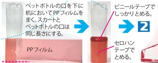
ペットボトルの口を下に机においてPPフィルムをまく。スカートとペットボトルの口は同じ長さにする。
